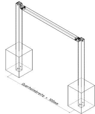
**3.** Die Querrohre auf die Aufnahmen der Standpfosten schieben und mit Schrauben fixieren
